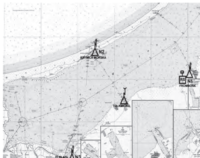
Rys. 1. Schematyczne rozmieszczenie stacji systemu RTK Zalew
