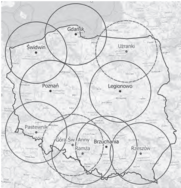
Rys. 10. Aktualne rozmieszczenie radarów sieci POLRAD, z nową lokalizacją radaru w Gdańsku i nowopowstałymi radarami w Uźrankach i Górze Św. Anny. Promienie działania radarów na rysunku wynoszą 125 km 16)
